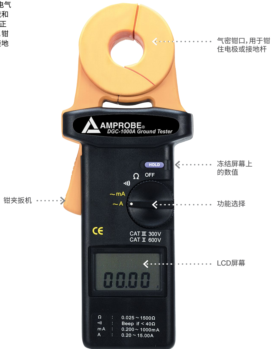
DGC-1000A 钳式接地电阻测试仪
